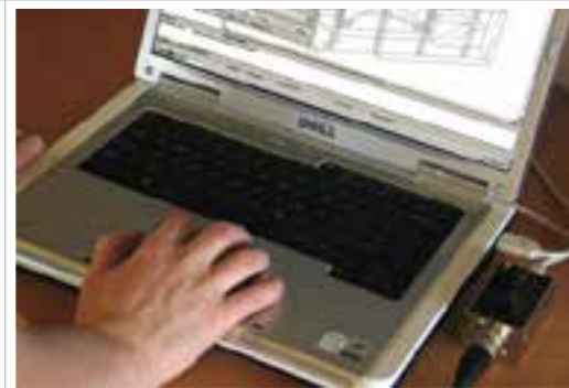
AXYS®WinControl通过电脑，在RS485网络上控制内置的DSP
